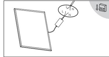
3. Dann mit dem Netzstrom verbinden (L-L ; N-N)
