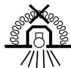
.... Leuchten sind nicht geeignet zur Abdeckung mit wärmeisolierendem Material
